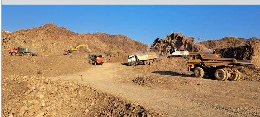
با طله سنگی و همچنین اجرای عملیات های انفجار و با طله برداری جهت بازگشایی جبهه های کاری در حال انجام می باشد.
